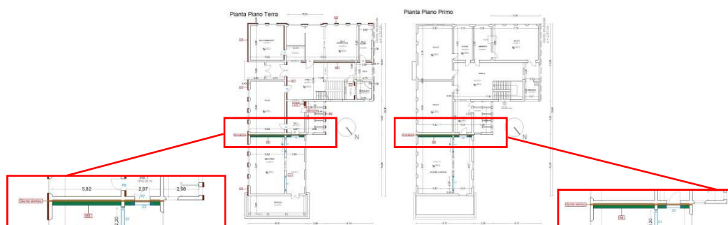
Figura 1.5: Realizzazione giunto sismico e costruzione nuova parete in muratura
