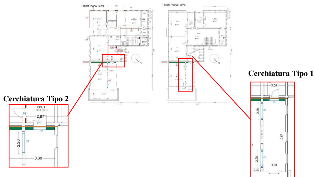
Figura 5.52: Realizzazione cerchiature di pareti murarie mediante profili metallici
