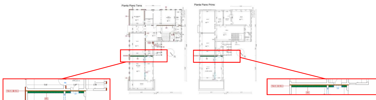
Figura 1.5: Realizzazione giunto sismico e costruzione nuova parete in muratura
