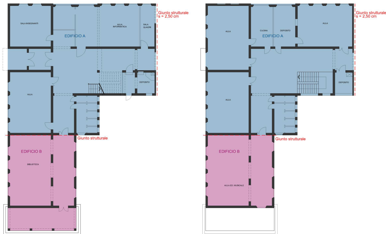
Figura 5.1: suddivisione del fabbricato in unità strutturali indipendenti, edifici A e B, e localizzazione dei giunti strutturali
